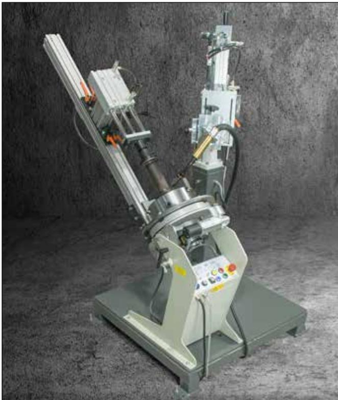
Drehtisch D302/60 auf Sockel mit 3-Backen-Futter, pneumatischer Brennerzustellung und Gegendruckpinole.
