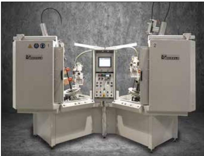
Doppel-Rundnaht-Schweißautomat mit zwei Drehtischen und zentraler Steuerung.
