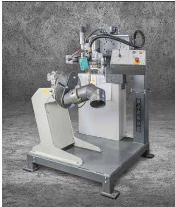
Drehtisch D302/60 auf Sockel mit automatischer Schweißnahterkennung durch Laserabtastung.
