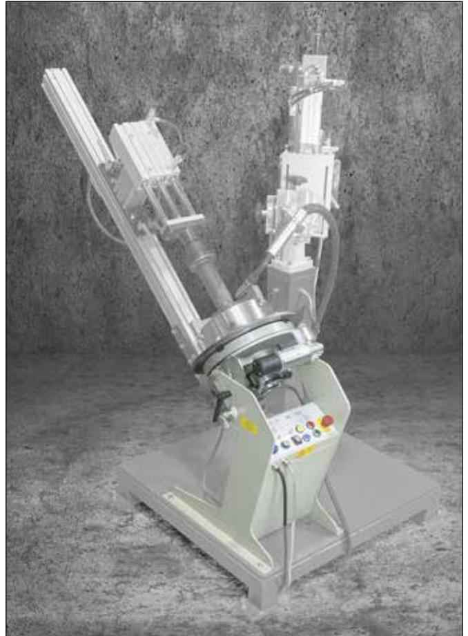
Rundnahtschweißanlage mit pneumatischer Gegendruckpinole und Brennerzustellung.
