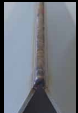
Hochfrequenz-Pulsen für perfekte Ecknähte
